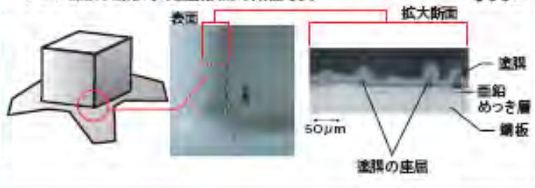
PCM深絞り成形時の塗膜損傷の断面写真
