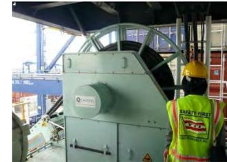
陸電使用のためのコンテナ船設備
