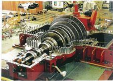
・蒸気タービン
