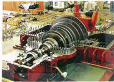
・蒸気タービン
