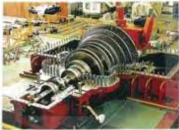
・蒸気タービン
