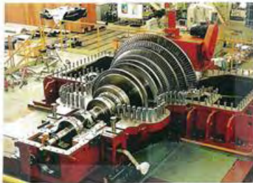
・蒸気タービン
